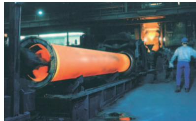
Duktile Gussrohre werden im Schleudergussverfahren hergestellt.
