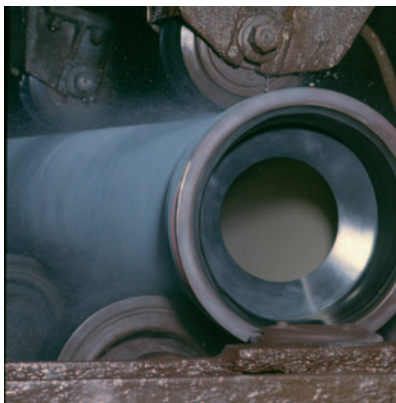
Innenbeschichtung der duktilen Gussrohre mit Zementmörtel.
